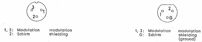
Abb. 8 Links Ansicht der Lötseite des 3pol. Zwergsteckers Preh 6999 zur Abnahme der Modulation am Netzanschlußgerät M 950 und Kontaktbelegung. Rechts Ansicht der 3pol. Kupplungsdose Cannon UA-3-11 zur Abnahme der Modulation am Netzanschlußgerät M 950 E und Kontaktbelegung. Left hand: View to the soldering side of the 3pole miniature plug Preh 6999 for connection of the modulation line to the power supply unit M 950, showing the connections of the tags. Right hand: View to the 3pole coupling socket Cannon UA-3-11 for connection of the modulation line to the power supply unit M 950 E, showing the connections of the tags.
